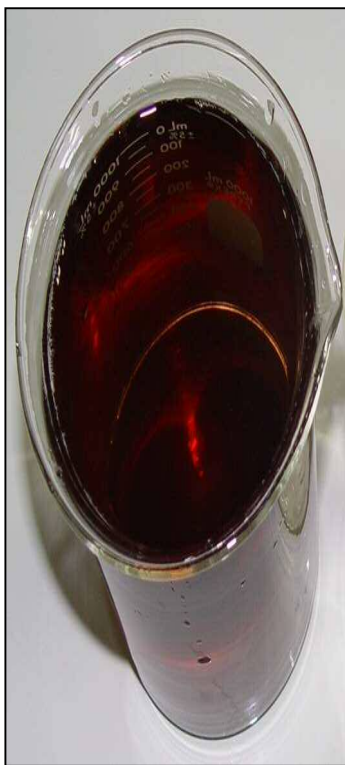
沉淀池出水 498 (CU)
